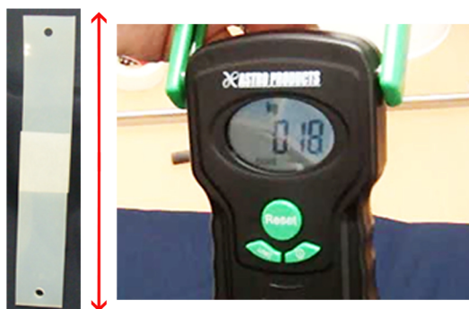
「極」処理なし 引張強度 0.18kg
